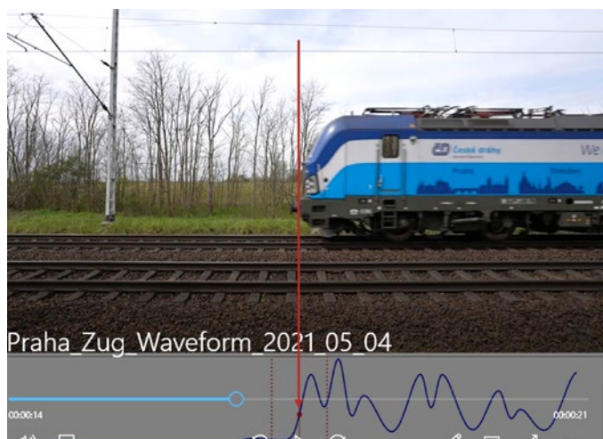
Bild 6: Signalmodulation über die Zeit gemessen mit FOS bei der Zugdurchfahrt
